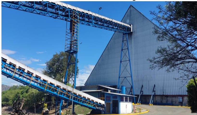
Figura N° 24. Sistema de bandas transportadoras saliendo de la bodega de almacenamiento de azúcar.
