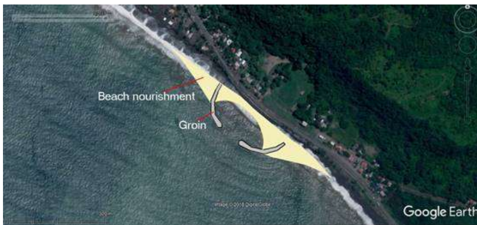
Figura 7-68: Cala – protección local de la carretera
