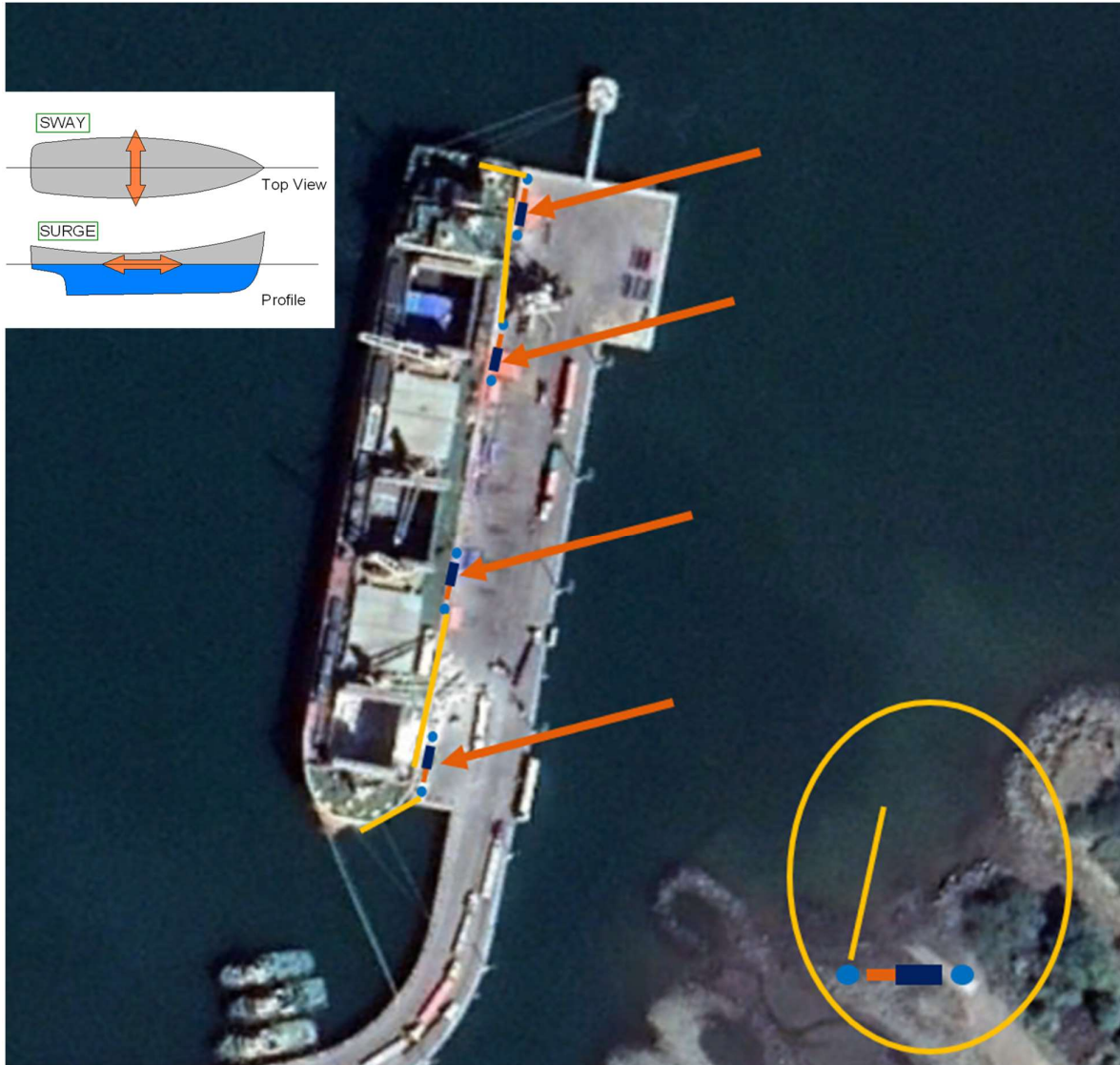
Figura 7-63: Movimientos de balanceo y sobretensión de la embarcación y configuración de amarre propuesta con módulos Shoretension
