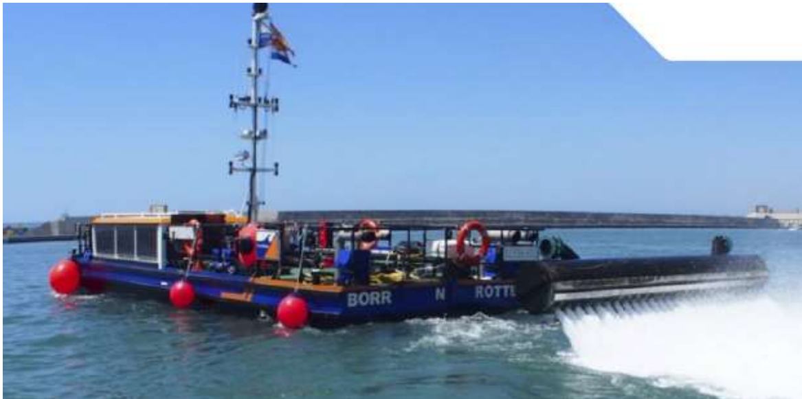
Figura 7-26: Ejemplo de draga de inyección de agua (fuente: Van Oord)
