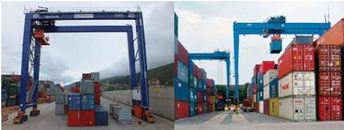
Figura 7-36: Fotos de RTG's (fuente: Konecranes/Porttechnology and Kalmar)
