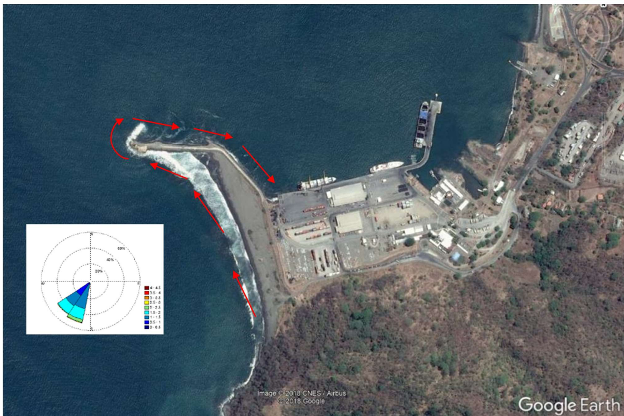
Figura 7-2: Dirección de sedimentos, causando sedimentación en el borde del rompeolas (fondo: imagen de Google Earth de abril de 2016), Fuente clima de oleaje Ref. [14]
