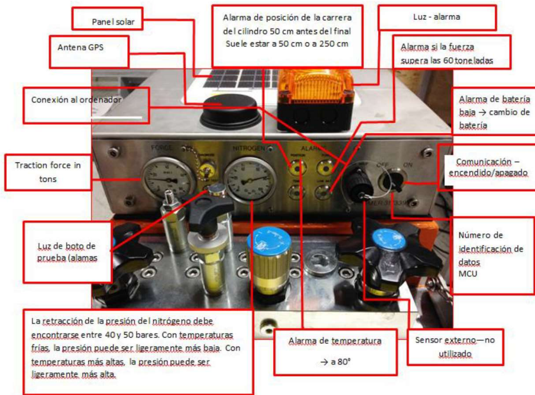
Figura 7-62: Explicación del sistema de visualización ShoreTension (fuente ShoreTension BV)
