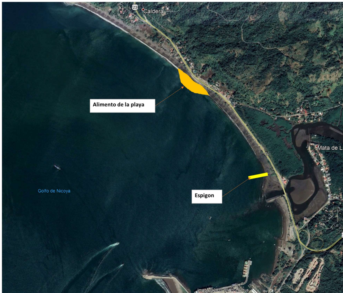
Figura 7-69: Diseño de alimentación de playa y espigón para estabilizar la playa, al norte del puerto de Caldera. Diseño conceptual de espigón
