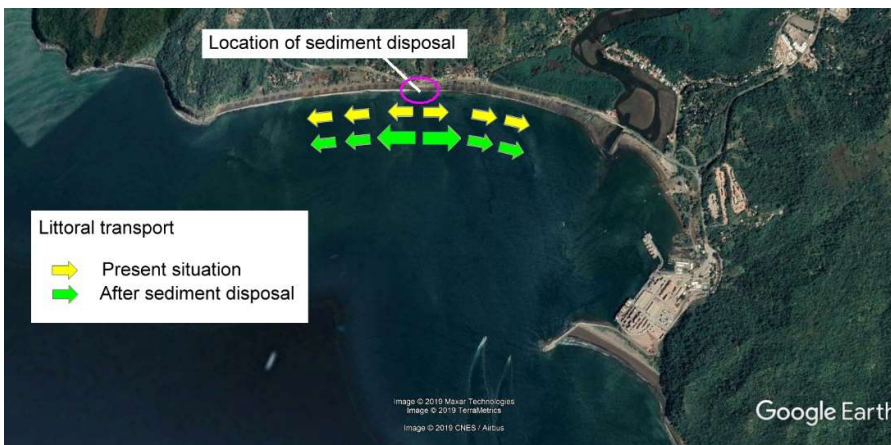
Figura 7-67: Ilustración del transporte del litoral para la situación presente y después de la disposición de los sedimentos Dragados
