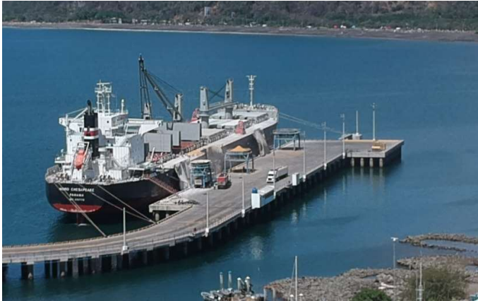
Figura 3-42 Descarga de un granelero seco con el equipo del buque en el atraque 4
