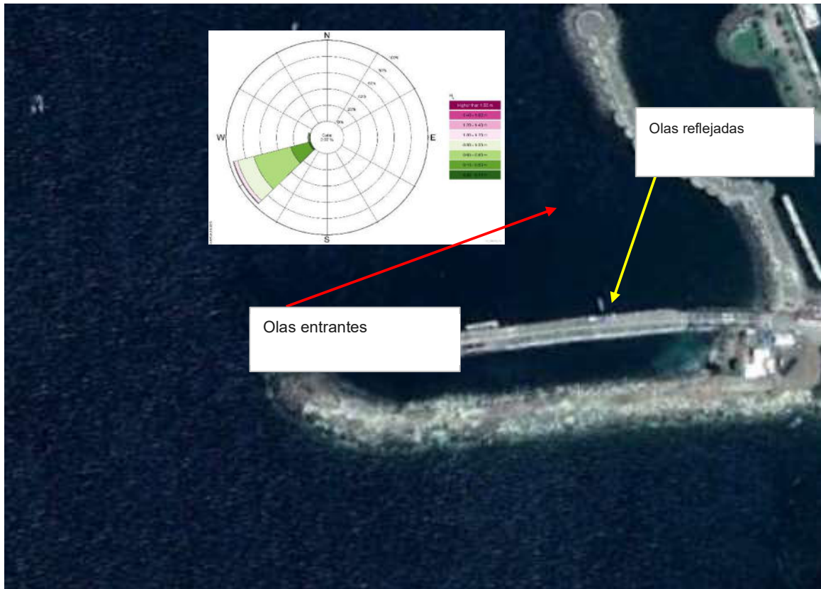
Figura 5-5 Olas entrantes del océano y olas reflejadas del rompeolas de la marina, muelle de Quepos
